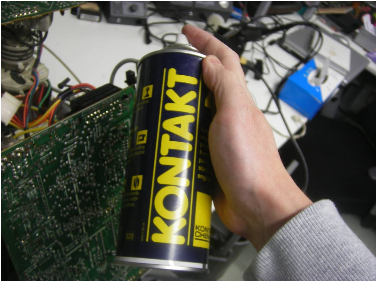
Gebruik contactspray bij alle regelaars
